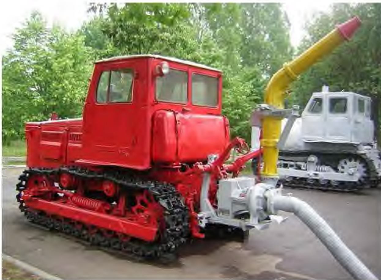
Рисунок 3.10 – Дождеватель дальнеструйный ДДА 100
